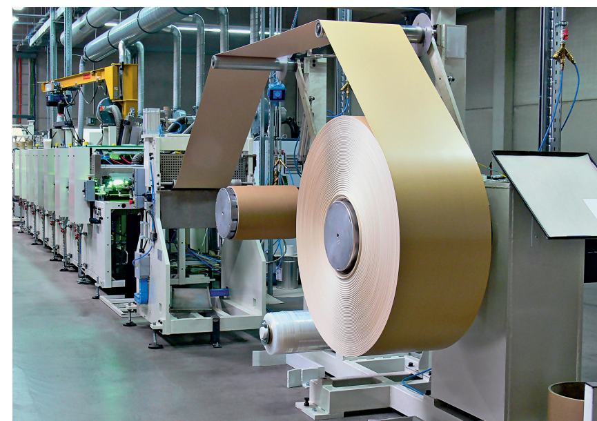
Die Kantenbandrollen werden von der Breite her so aufgetrennt, wie der Kunde es wünscht
