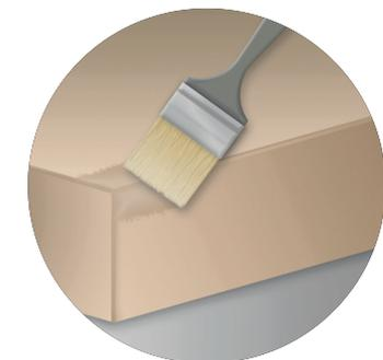
Nach ungefähr 15 Sekunden können Fluidreste mit einem sauberen Mikrofaser Tuch aufgenommen werden. Das Einbrennen ist bei bis zu 80°C möglich.
